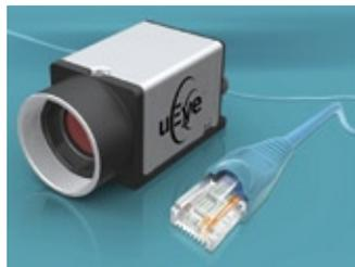
UI-5220CP ist mit einem 100 Bilder/s schnellen WVGA-Chip ausgestattet; als dritte Variante bietet die UI-5240CP einen neuen Global-Shutter-Sensor mit 1,3 Megapixel und 50 Bilder/s. Dieser ist besonders empfindlich und eignet sich für schnelle Inspektionsaufgaben ebenso wie für die Mikroskopie. Die weiteren technischen Daten sind identisch mit denen der bekannten Modellreihe Gige u Eye SE. [t.schmidgall@ids-imaging.de](mailto:t.schmidgall@ids-imaging.de) ■
