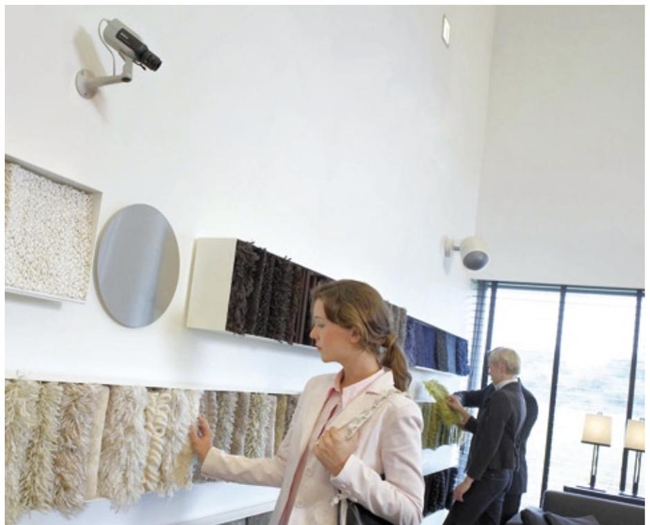
werden alle „Ereignisse“ am Kamerastandort generiert und nur noch Videobilder von Interesse an die Leitstelle gesendet, was den Datenverkehr im Netzwerk deutlich reduziert. Alle anderen Aufnahmen werden lokal oder auf iSCSI-Laufwerken, welche sich an beliebigen Stellen im Netzwerk befinden können, gespeichert. Solche Installationen eignen sich ideal für die Videoüberwachung in weitläufigen Kaufhäusern oder Shopping Centern.
