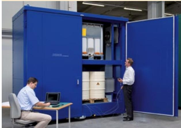
Ermittlung der optimalen Heizleistung in einer Denios-Test-Wärmekammer.
