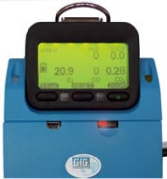
station TS400, Netzteil und Kfz-Adapter gibt es einen praktischen und robusten Einsatzkoffer. Im Vergleich zur Durchführung des Anzeigetests manuell oder über Kalibrierstationen verringert sich der Aufwand rund um den Anzeigetest um ca. 50%. Gleichzeitig ermöglicht die Teststation, dass die laufenden Betriebskosten – Gasverbrauch, Erstellung der Dokumentation – erheblich gesenkt werden. [www.gasmessung.de](http://www.gasmessung.de) ■
