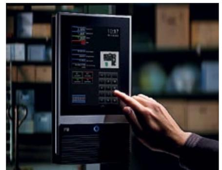
ler berichtet. Dazu trägt insbesondere das hochauflösende Farb-Display bei. Ein projiziert kapazitiver Touchscreen, wie man ihn von modernen Tablet PCs kennt, ermöglicht die Bedienung ähnlich einem Smartphone einfach mit einem Fingerstrich. [intus@pcs.com](mailto:intus@pcs.com)
