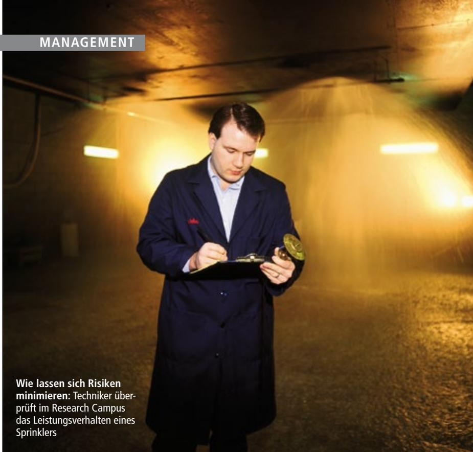
**Wie lassen sich Risiken minimieren:** Techniker überprüft im Research Campus das Leistungsverhalten eines Sprinklers
