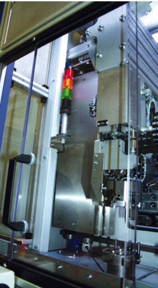
▲ In einem Auswuchtprüfstand für Turbolader-Rumpfguppen, der nach Ungarn geliefert wurde, hat das Sondermaschinenbau-Unternehmen Böhmer erstmals das Modulare Sicherheitssystem MSS Advanced von Siemens in Verbindung mit ASIsafe eingesetzt. Das Ergebnis: einfachere Konstruktion und beschleunigte Installationen.
