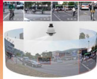
Der hochempfindliche Tracking-Roboter DiSCAN-PTZ ist ein aktives Multikamerasystem für automatische PTZ-Objektverfolgung mit mehreren statischen Panorama-Beobachtungszonen und IP-Aufzeichnung auf NAS-Geräte. Das optische System ist betriebsbereit vor-
