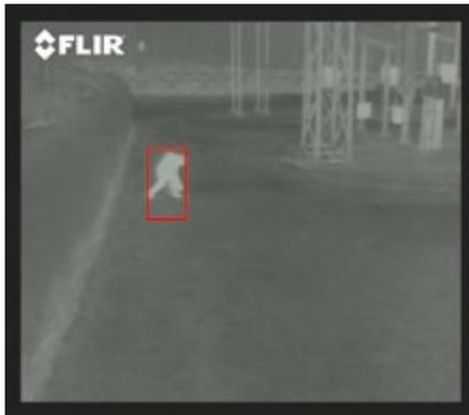
▲ Durch die klaren und kontrastreichen Aufnahmen der Wärmebildkameras kann eine Videoanalyse-Software automatisch unbefugte Personen bei Tag und Nacht sowie bei allen Wetterverhältnissen entdecken.
