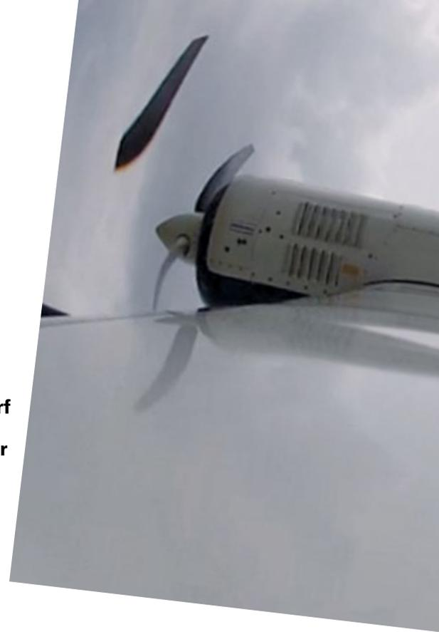
GIT-SICHERHEIT.de zeigt im Video, am Beispiel eines Flugzeugpropellers, wie Verzerrungen durch den Rolling-Shutter-Effekt entstehen können.
