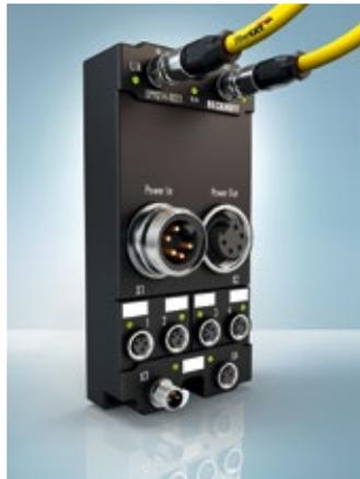
fehlerfrei funktionieren. Die Power-Box EP9214 bietet für diese Fälle eine Lösung. Ausgestattet mit 7/8-Zoll-Steckverbindern erlaubt sie – bei Leitungsquerschnitten von 1,5 und 2,5 mm – 16 A Summenstrom je Steuer- und Peripheriespannung. Kurzzeitig sind sogar wesentlich höhere Anlaufströme der Ausgänge zulässig, sodass der Hochlauf der angeschlossenen Geräte gewährleistet ist. [www.beckhoff.de](http://www.beckhoff.de)
