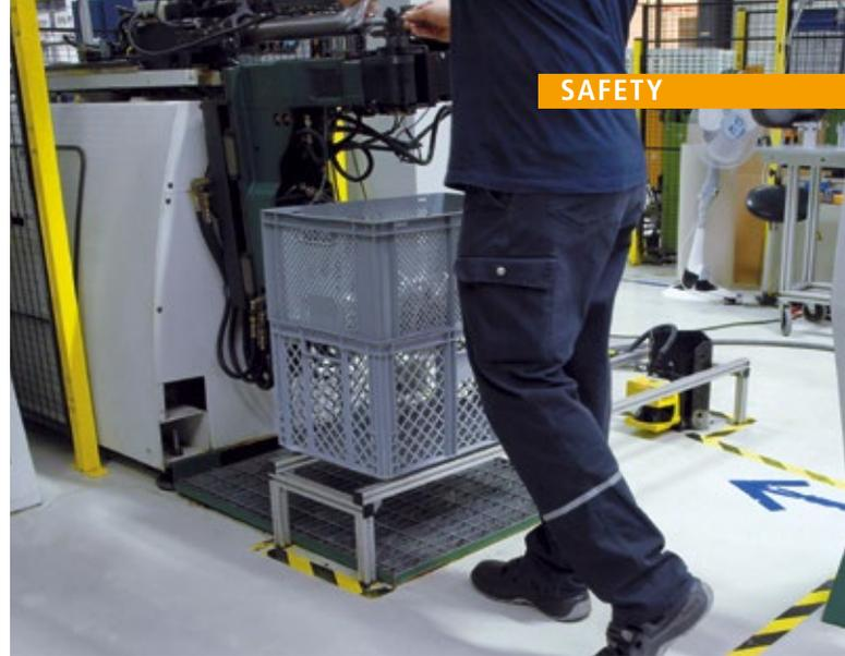
▲ **Sicherheits-Laserscanner Rotoscan RS4 schützen die Bediener.** Sie sichern die Gefahrenbereiche an den Rohrbiegemaschinen. Das Schutzfeld an jeder Rohrbiegemaschine ist durch eine Farbbandmarkierung gekennzeichnet. Die Definition der Schutzfeldgeometrie erfolgt durch Parametereinstellungen, die im ConfigPlug-Anschlussstecker gespeichert bleiben
