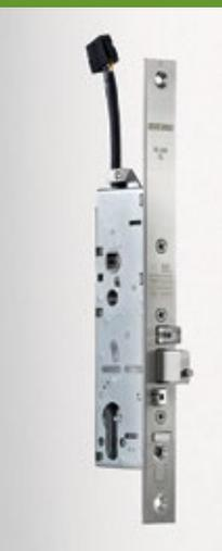
Schnelle Öffnung im Notfall und kontrollierter Zutritt sind die Stärken von selbstverriegelnden Panikschlössern. Mit dem IQ lock AUT bietet Geze eine multifunktionale Systemlösung für Vollpaniktüren mit beidseitig automatisierten Türflügeln. Gang- und Standflügel können damit motorisch entriegelt werden. In Kombination mit Zutrittskon-
