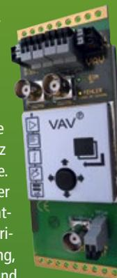
gnalabhängig Rauschfilter und überwacht alle Funktionen. Die integrierte Datenschnittstelle ermöglicht Fernüberwachung, Kamerasteuerung (Sternverteiler), Konfiguration oder Texteinblendung per OSD (POS). Die Inbetriebnahme beschränkt sich auf den werkzeugfreien Anschluss der Ein- und Ausgangskabel und einer AC/DC-Versorgung.
