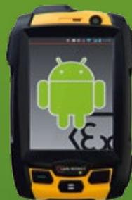
Rückkamera mit 5 Mega-Pixel und Blitz ermöglicht den Einsatz als Barcodescanner zu verwenden. Navigation mit GPS, ermöglichen das Gerät auch zum Alleinarbeiter-schutz inklusive Personen-Ortung zu nutzen.
