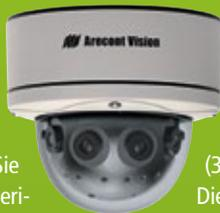
meras bedeutet die WDR-Leistung der Arecont Vision Kameras einen um bis zu 50dB verbesserten (300x) Dynamikbereich. Die Kamera verwendet vier 3 MP WDR Bildsensoren für eine Gesamtauflösung von 8192 x 1536 Pixel. Das Gehäuse ist gemäß IP66 und IK10 gefertigt.
