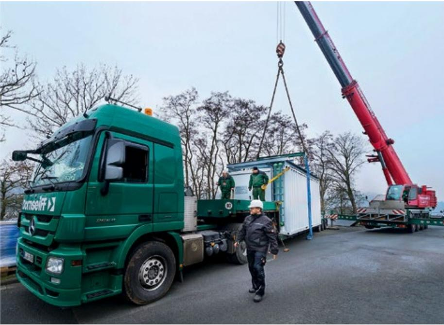
Ein 400 PS-starker Autokran hebt den 10 Tonnen schweren Container auf den Tieflader für den Transport nach Aschaffenburg
