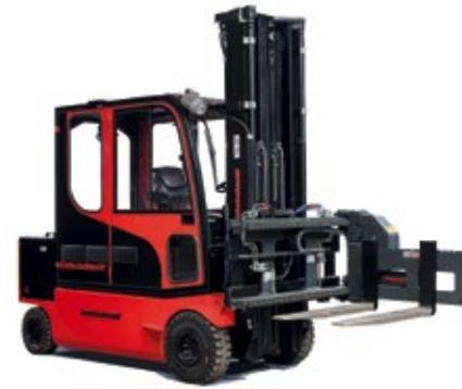
und Scheibenwischern (natürlich alles in ATEX-konformer Ex-Ausführung) sowie Superelastik-Bereifung auf. Durch den dynamischen 80-V-ASM-Antrieb in Drehstromtechnik können dauerhaft hohe Umschlagsleistungen erbracht werden.
