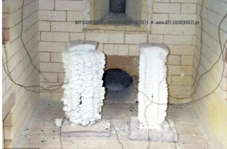
Links: Stahlsäulen mit einer dämmschichtbildenden Beschichtung aus der Firetex FX-Serie.
