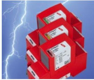
Geräte sind Typ 2-Ableiter (SPD Typ 2) und entsprechen den normativen Anforderungen der DIN EN 61643-11. Sie weisen bei einer Nennspannung von 230 V AC einen Schutzpegel von  $\leq 1,5$  kV auf und sind von 75 V AC bis 1000 V AC erhältlich. Als Einzelgeräte oder aber in Kombination ermöglichen sie immer die richtige Schutzbeschaltung. ■
