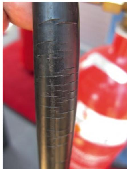
**Löschmittelschlauch eines Kohlendioxidlöschers mit Schädigungen durch Umwelteinflüsse – Risiko bei der Benutzung; Ersatz durch Originalersatzteil**
