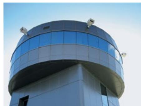
Die Kameras des Systems für das Projekt Airfield: Mit drei halbkreisförmig angeordneten Systemen wird ein Überblick von 228° erreicht
