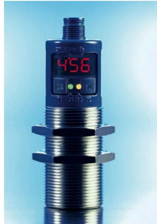
in Industrie und Landwirtschaft, auch für Außenanwendungen. So werden mit dem Ics+600 trotz hoher Staubentwicklung zum Beispiel Füllstände in Kiessilos mit einer Auflösung von 0,18 mm erfasst. Körner, die beim Befüllen durch Silo oder Tank fliegen und die Messung stören könnten, werden mit Hilfe spezieller Filter ausgeblendet, sodass der Ultraschallsensor nur den tatsächlichen Füllstand anzeigt.
