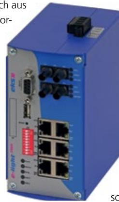
Description Markup Language) komfortabel eingebunden werden. Neben sechs Twisted Pair-Ports (10/100 BASE-TX) sind zwei optische Uplinks (100 BASE-FX) vorhanden, mit denen sich je nach Lichtwellenleitertyp Entfernungen von bis zu 30 km überbrücken lassen. Redundanzverfahren wie MRP (Media Redundancy Protocol) ermöglichen hochverfügbare Ringtopologien mit einer Umschaltzeit von 200 ms und weniger.
