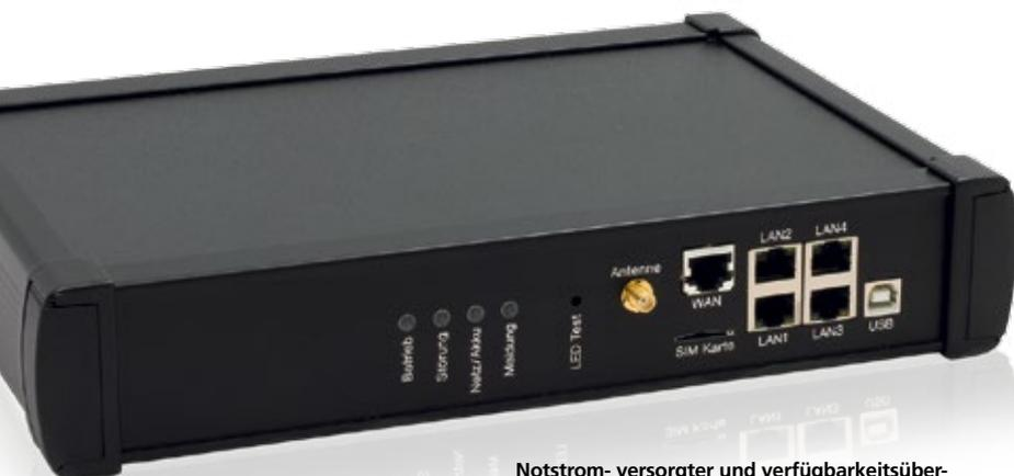
Notstrom-versorgter und verfügbarkeitsüberwacher Sicherheitsrouter SIRO-Port
