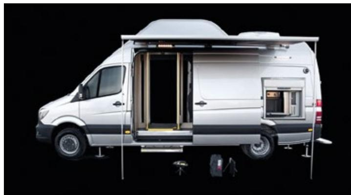
**Menschen und Gepäckstücke werden im Wagen durch begehbare Slots gescannt und können zusätzlich mit mobilen Scannern außerhalb des Fahrzeugs verbunden werden**
