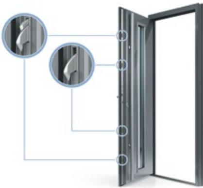
Die massiven Schwenkriegel der Sicherheits-Tür-Verriegelung Autolock AV3M4 von Winkhaus verkallen sich schon beim Zuziehen der Tür in die Rahmenseite und bremsen Einbrecher aus
