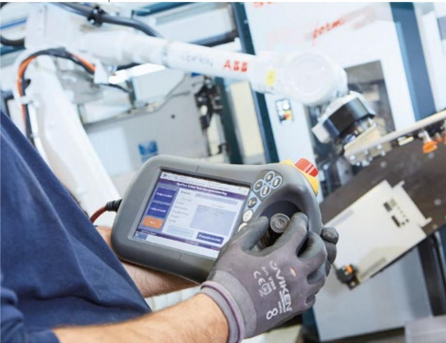
Der Roboter programmiert sich automatisch. Der Bediener muss lediglich einige Fragen beantworten und dem Roboter ein paar einfache Bewegungen einlernen
