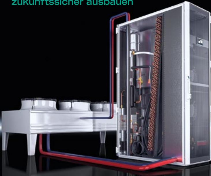
Natürliche Kühlung nach Bedarf: Das neue LCP DX/FC Hybrid von Rittal verfügt sowohl über einen Kältemittelkreislauf als auch über einen separaten Wasserkreislauf. Bei niedrigeren Temperaturen wird automatisch die indirekte freie Kühlung genutzt. Die Basis für die kostengünstige Lösung ist ein externer Hybridverflüssiger, in dem ein Freikühler integriert ist.
