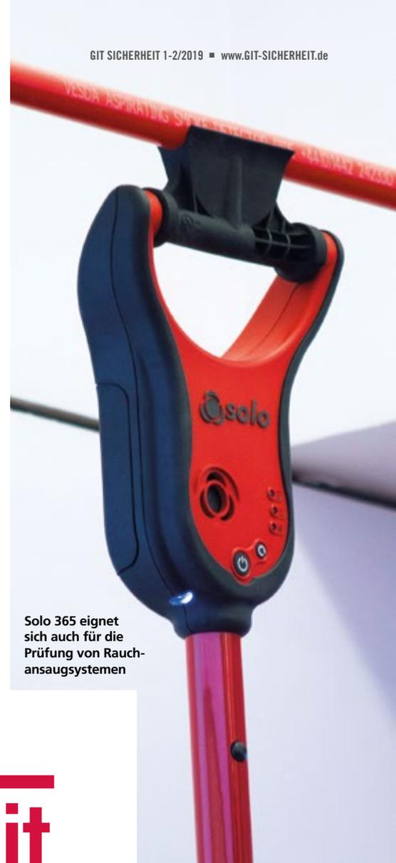
Solo 365 eignet sich auch für die Prüfung von Rauchansaugsystemen
