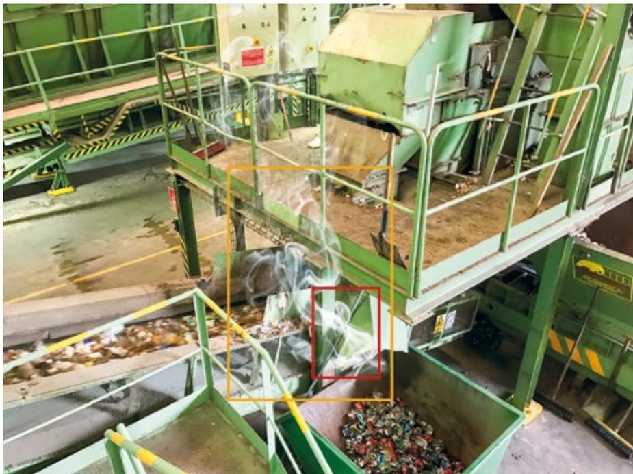
▲ In staubigen Werkshallen und in hohen Produktionsstätten funktioniert die videobasierte Rauchfrüherkennung erheblich schneller als herkömmliche Brandmelder. Aber auch Recyclingwerke oder chemische Anlagen profitieren von dem zuverlässigen System.
