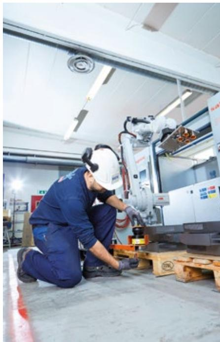
**Sofort einsatzbereit: Mit einem Flurförderzeug wird der mobile Roboter von OpiFlex in einer Produktion zur passenden Arbeitsstation gefahren, dort fest an einer vorher installierten Plattform angedockt und eingesteckt**
