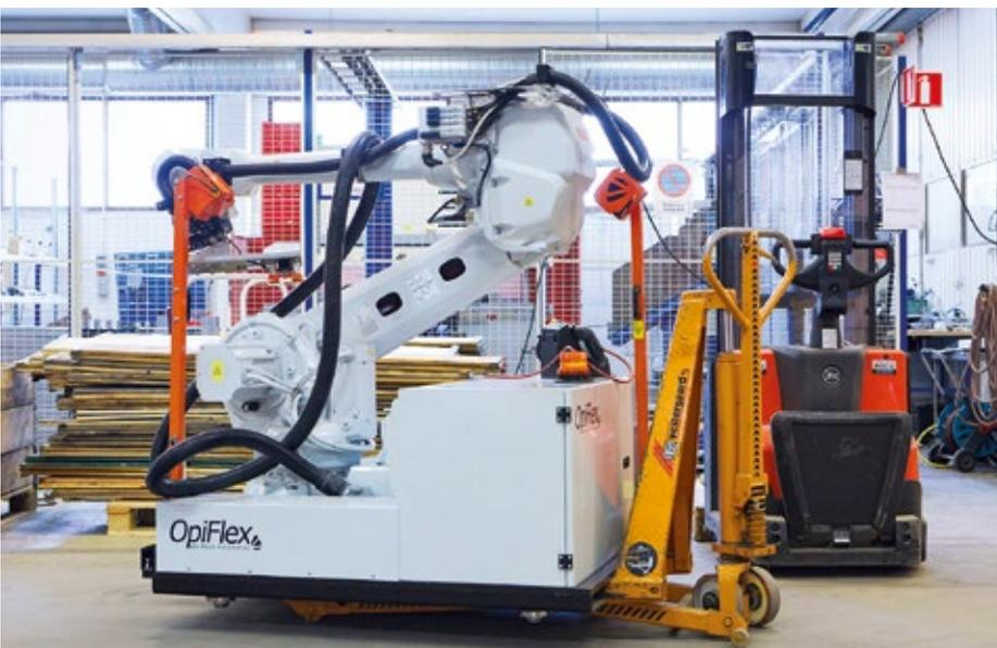
Zwei Sicherheits-Laserscanner S300 Mini Remote von Sick gewährleisten den Betrieb bei voller Geschwindigkeit, weil sie Personen rund um die Station erkennen
