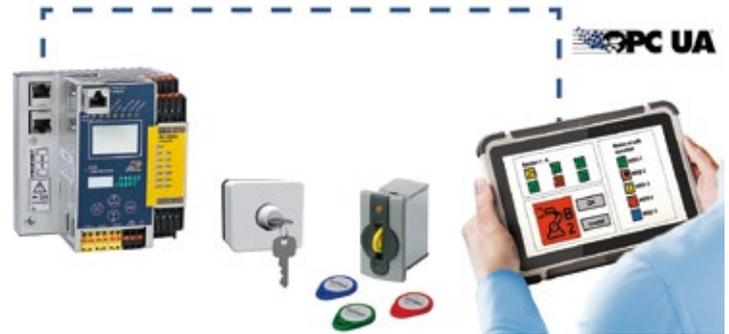
Einfache Integration über OPC UA und Zugangsregelung – entweder über einen sicheren Schlüsselschalter oder ein auf Transponder-Technologie basierendes System wie z.B. das EKS FSA von Euchner
