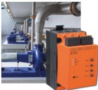
im besonders kritischen Moment des Startvorgangs und schont die Motoren und angetriebenen Maschinen. Das robuste elektronische Steuergerät vereint Funktionen wie z.B. das sanfte An- und Auslaufen von Drehstrom-/Asynchronmotoren, einen integrierten Motorschutz nach Klasse 10 sowie Anlaufstrombegrenzung, Thyristorüberwachung und das Erkennen von fehlender Last. Das Gerät hat eine Baubreite von nur 67,5mm.
