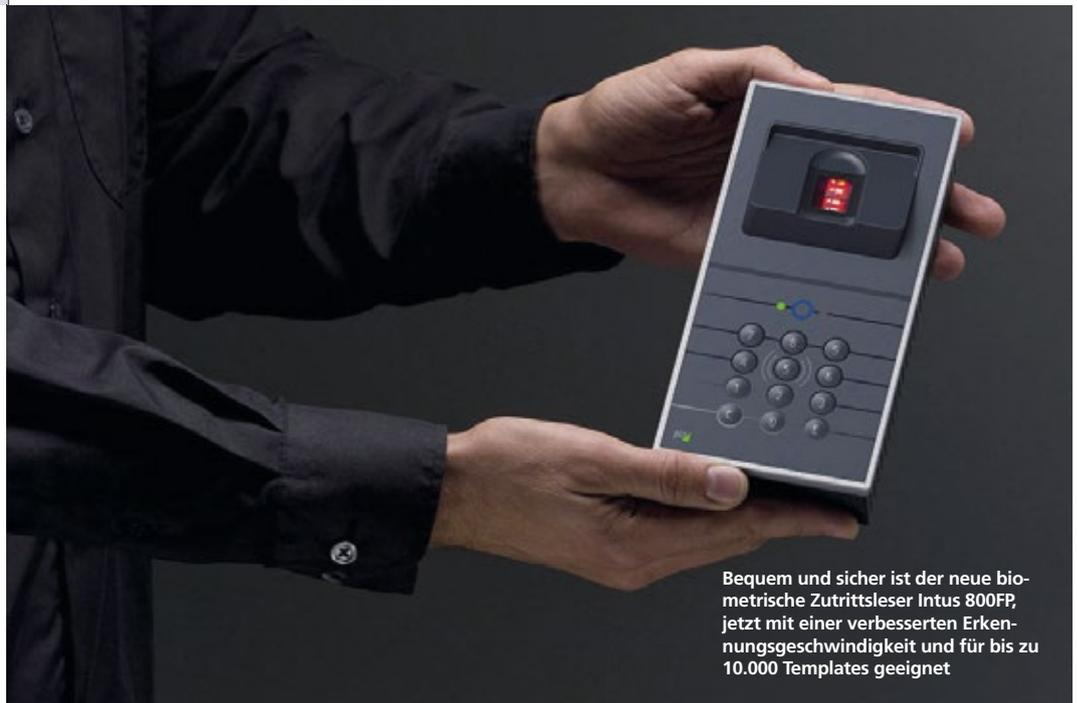
Bequem und sicher ist der neue biometrische Zutrittsleser Intus 800FP, jetzt mit einer verbesserten Erkennungsgeschwindigkeit und für bis zu 10.000 Templates geeignet
