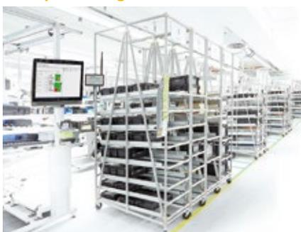
Produktionslogistik. Intelligente Meldepunkte gewährleisten im FiFo-Regal volle Transparenz über den Materialbestand und schützen dank automatisierter Materialanforderung vor Fehlbestückung oder Leerlauf. AndonSpeed ist ein Call-for-Action-System speziell für Versandzentren. Die Lösung für Verpack- und Ver-
