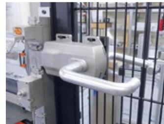
in geöffneter Stellung bis zu drei Vorhängeschlösser eingehängt werden, um den Schutz vor unbeabsichtigter Einspernung zu gewährleisten.
