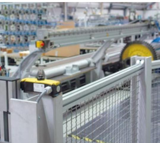
**Damit die gesamte Produktion inklusive Schutztüren und Zusatzfunktionen wie Kröpfmaschine und Haspel einfach abgesichert ist, lassen sich die Positionsschalter Sirius 3SE5 von Siemens flexibel an die Sicherheitstechnik anbinden**
