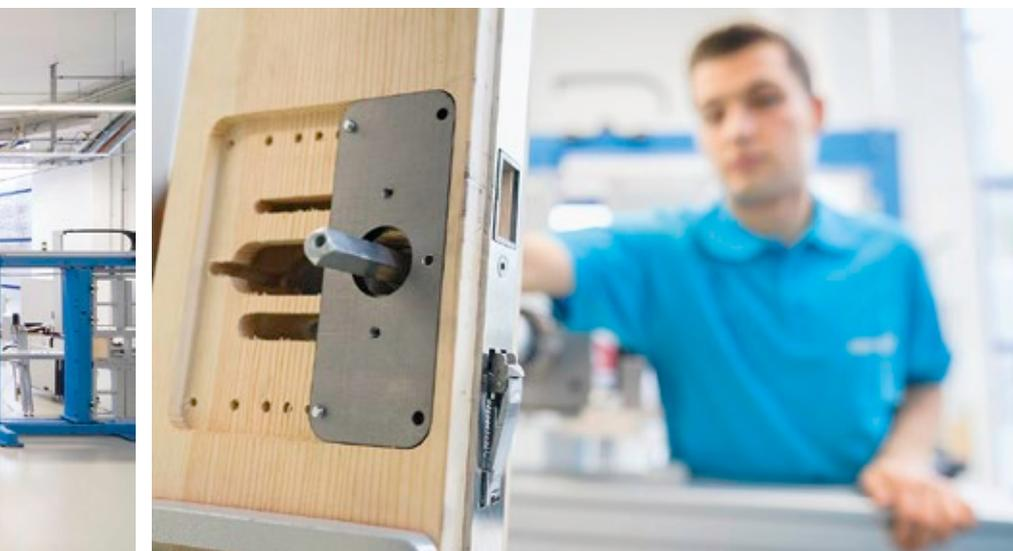
Manuelle Funktionsprüfungen wie hier bei einem Panikgegenkasten werden ebenfalls vorgenommen
