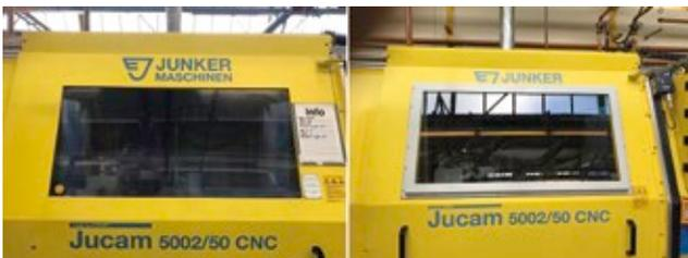
▲ Vorher und nachher: Die alte Schutzscheibe (links) ist erkennbar abgenutzt. Nach dem Scheibentausch (rechts) werden wieder alle aktuellen Anforderungen an die Arbeitssicherheit erfüllt
