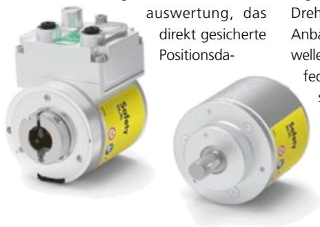
ten („Safe Position“ – SLP) ausgibt. Je nach Ausführung des Drehgebers für die höchste Sicherheitsstufe SIL3 bzw. PLE oder auch als an die Erfordernisse angepasste Variante für SIL2/PLD-Anwendungen. Dabei fügt sich dieser ultrakompakte SIL-Drehgeber in die verschiedensten Anbausituationen ein: Bei der Vollwelle sorgen eine Nut und eine Passfeder für den notwendigen Formschluss zwischen Anwendung und Sensor, bei Sackloch- und durchgehenden Hohlwellen bis zu 15mm eine Nut in der Hohlwelle.
