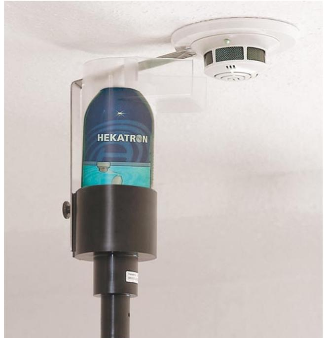
Mit den praktischen Prüfinstrumenten und dem Inbetriebnahme- und Wartungsset von Hekatron wird die Wartung leicht gemacht.
