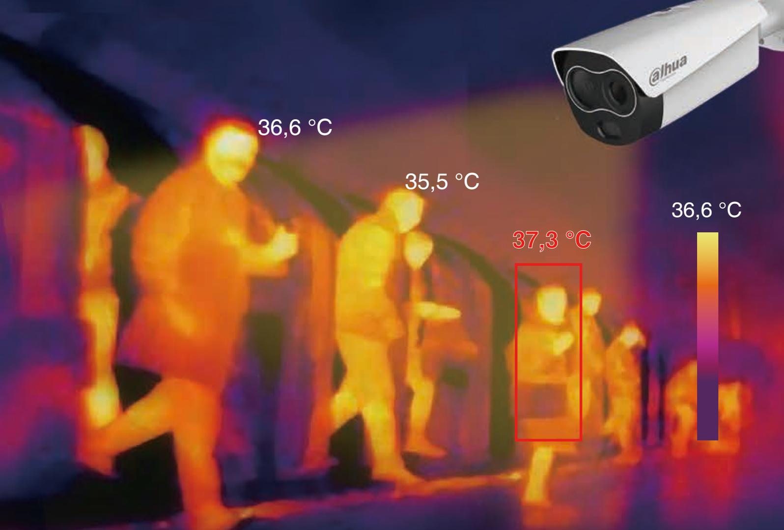
Dahua Technology veröffentlicht die branchenweite neueste Wärmekamera, die Körpertemperaturen sehr präzise mit einer Genauigkeit von  $\pm 0,3$  °C (mit schwarzem Körper) messen kann. Dank integriertem KI-Algorithmus kann sie mehrere Personen aus einer Entfernung von bis zu 3 Metern messen, was schnellen, kontaktlosen Zugriff ermöglicht.
