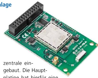
zentrale eingebaut. Die Hauptplatine hat hierfür eine entsprechende Steckverbindung. Das Modul kann mit einer auf der Platine integrierten oder einer externen Antenne betrieben werden. Die externe Antenne wird direkt am Modul angeschlossen. Das Mobilfunkmodul überträgt Alarmmeldungen an eine Leitstelle oder an ein privates Kommunikationsendgerät via Mobilfunk.
