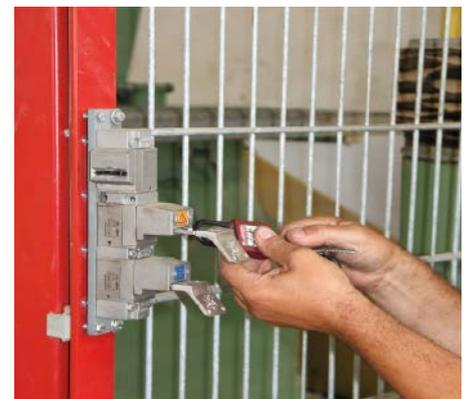
▲ Ein LOTOTO-Modul an der Tür verhindert, dass diese geschlossen wird, wenn sich noch ein Mitarbeiter an der Anlage befindet
