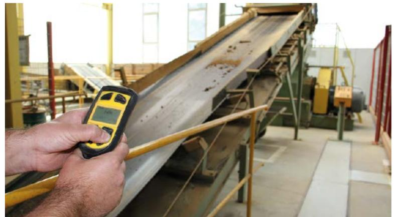
▲ Mit dem Zustimmungstaster der Safemaster W Serie meldet sich der Mitarbeiter über Funk an und kann dann einzelne Antriebe gezielt anschalten
