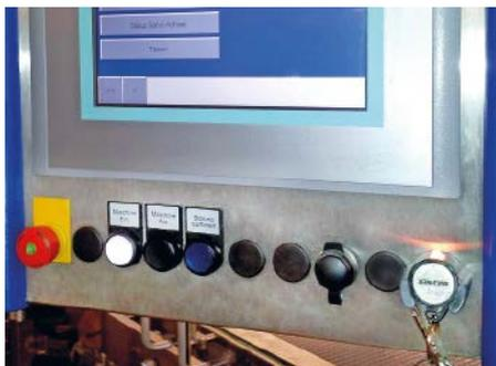
Rechts an der Bedienungseinheit: die modulare Schlüsselaufnahme von EKS Light
